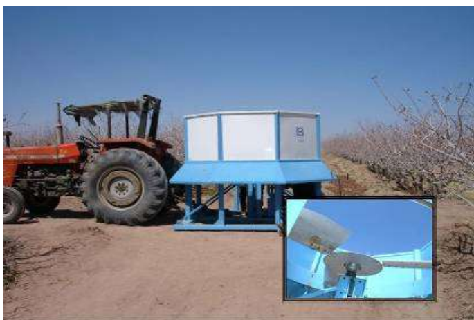
شکل ۵- چاهک معکوس با استفاده از نیروی P.T.O تراکتور
