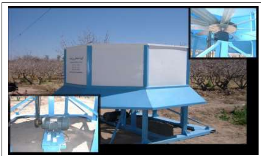
شکل ۶- چاهک معکوس با استفاده از نیروی الکترو موتور
